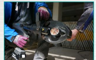
Mit diesem Akku-hydraulischen Schneidwerkzeug können Sie armierte Kabel bis  $\varnothing$  105 mm, Seekabel bis  $\varnothing$  80 mm oder Erdkabel wie NYY 4 x 240 mm<sup>2</sup> schneiden. Damit deckt dieses Werkzeug typische Anwendungen im Bereich Stadtwerke, Elektroindustrie und Energieversorger ab.
