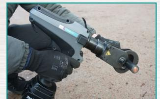
Mit diesem Akku-hydraulischen Schneidwerkzeug können Sie ein breites Anwendungsspektrum abdecken - es schneidet Drahtseile, Kabel, Fahrdrähte sowie Massivleiter; mit einem optionalen Feinschliff können Sie sogar fein-/feinstdrähtige Leiter durchtrennen. Die offene Schneidgeometrie macht das Arbeiten mit dem CutMax-C3 besonders einfach und begeistert Anwender in Industrie und Verkehrstechnik.
