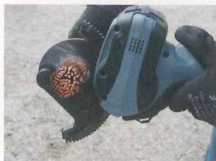
Mit dem modifizierten, akkubetriebenen Kabelschneider RS 5-F von Holger Clasen lassen sich fein- und feinstdrähtige Kupfer- und Aluminium-Litzenleiter der Klassen 5 und 6 bis 630 mm<sup>2</sup> schneiden. Dank sichelförmiger Schneidgeometrie mit Feinschliff gelingt ein glatter und präziser Schnitt ohne zu verklemmen. *»Die Arbeit unserer Kunden zu erleichtern und dabei ein hohes Maß an Prozess-*
