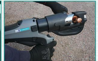
Dieses vielseitige, leistungsstarke Akku-hydraulische Presswerkzeug verarbeitet mit handelsüblichen C-Schalen-Presseneinsätzen Kabelschuhe und Verbinder bis 300 mm<sup>2</sup> nach DIN. In seiner Vielseitigkeit findet es Einsatz in den Bereichen EVU, Stadtwerke, der industriellen Kabelmontage oder der Windenergie.
