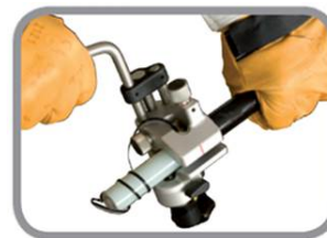
Äußere Leitschicht schälen Peeling outer conducting
