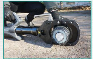
Die InLineBox-CS13 - das Werkzeug, wenn es um große Schneidanwendungen geht und Sie nicht auf die Flexibilität von handlichen Akku-Werkzeugen verzichten möchten. Die InLineBox-CS13 schneidet mit einer Öffnungsweite von 132 mm neben Kabeln und Vollmaterialien auch Telefonkabel kraftvoll, schnell und sicher. Die ergonomische Bauform mit niedrigem Schwerpunkt bringt eine hohe Standsicherheit mit sich.
