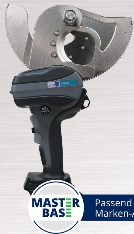
Der Freileitungsschneider durchtrennt schnell und kraftvoll Al/St-Seile bis  $\varnothing$  54 mm mit einem Stahlanteil bis 70 mm<sup>2</sup>, wie 550/70. Im Freileitungsbau überzeugt dieses leichte, ergonomische Werkzeug durch sein gutes Schnittbild und die hohe Effizienz dank gut abgestimmter Antriebseinheit.
