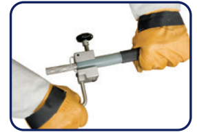
Anfasen der VPE-Isolierung Chamfering VPE insulation
