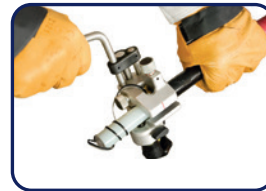
Äußere Leitschicht schälen Peeling outer conducting
