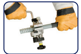
Isolierungschälen Peeling insulation
