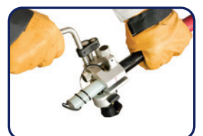
Äußere Leitschicht schälen Peeling outer conducting
