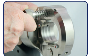
Sicherheitsverriegelung für zuverlässiges Schließen des Presskopfes Safety lock for reliable closing of the crimping head
