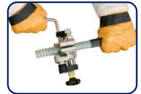
Isolierungschälen Peeling insulation
