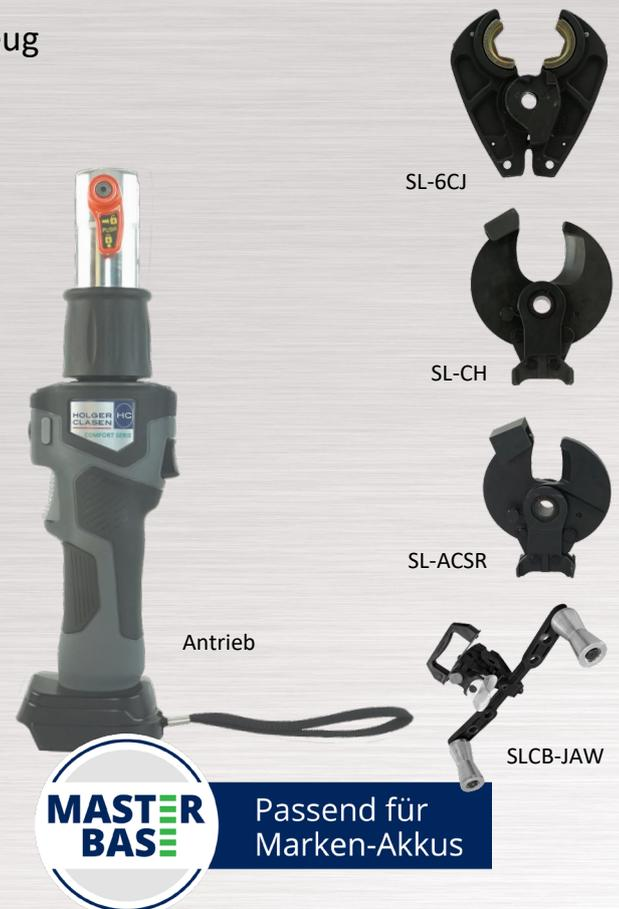
Pressen, Schneiden und Biegen: Das Werkzeug schneidet Cu-Kabel und Freileitung, verpresst Kabelschuhe und Verbinder mit schmalen C-Schalen-Pressseinsätzen (CS) bis 240 mm<sup>2</sup> nach DIN oder biegt Kabel bis 1000 mm<sup>2</sup>. Der Pull-Pin-Kopf sorgt für eine einfache und schnelle Montage. Das Werkzeug ist somit ideal für Elektromontage mit wechselnden Einsatzgebieten – mit Biegeaufsatz gerade bei Montagearbeiten im Schacht oder Elektroinstallationen in verwinkelten Bereichen.
