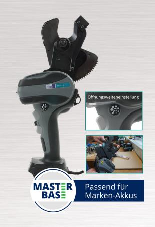
Der Akkuschneider mit seiner offenen Schneidgeometrie trennt präzise und schnell Cu- und Al-Seil und Energiekabel bis Ø 33 mm, Rundmaterial sowie Freileitungen bis Ø 18,6 mm (35 mm² max. Stahlanteil).
