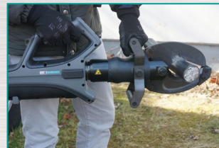
Der zusätzliche Handgriff erleichtert das Positionieren am Kabel
