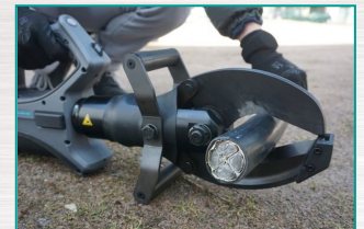
Der zusätzliche Handgriff erleichtert das Positionieren am Kabel
