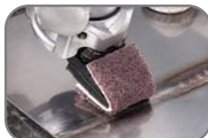
Entfernen von Schweißnähten mit Schleifplatte 26 x 50 mm. Removal of weld seams with rectangular pad 26 x 50 mm.
