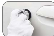
Lackbearbeitung mit Schleifteller Ø 50 mm. Varnish sanding with round pad Ø 50 mm.
