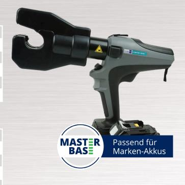
Das Akku-hydraulische Presswerkzeug verarbeitet selbstzentrierend über eine integrierte 4-Dorn-Verpressung nichtisolierte feindrähtige Kupfer-Leiter nach DIN 60228, Klasse 2, 5 und 6 im Bereich 10 - 240 mm² und findet Einsatz im Schaltschrankbau sowie bei Aggregatanschlüssen. Es werden keine Presseinsätze benötigt.
