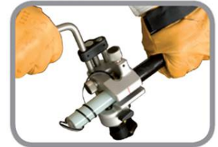
Äußere Leitschicht schälen Peeling outer conducting
