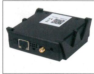
Einen Diebstahlschutz bietet der GPS-Tracker »Mi50« in Verbindung mit der elektronischen Wegfahrsperrung »Miblock« von **Moving Intelligence**. Sobald sich nach dem Abstellen des Motors der Active Tag, der zum Lieferumfang gehört, vom Fahrzeug entfernt, werden die Schaltkreise von Zündung oder Kraftstoffversorgung unterbrochen. Ein Starten ist erst dann möglich, wenn sich der Sender wie-
