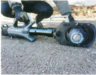
Mit der »Inlinebox-CS13« bietet **Holger Clasen** ein Werkzeug für große Schneidanwendungen, bei dem Anwender die Flexibilität eines Akku-Werkzeuges nutzen können. Die Kabelschere findet überall dort ihre Anwendung, wo große Schneiddurchmesser geschnitten werden und ein hohes Maß an räumlicher Flexibilität – wie zum Beispiel häufige Ortswechsel auf der Baustelle – erforderlich ist. Die Öffnungs-
