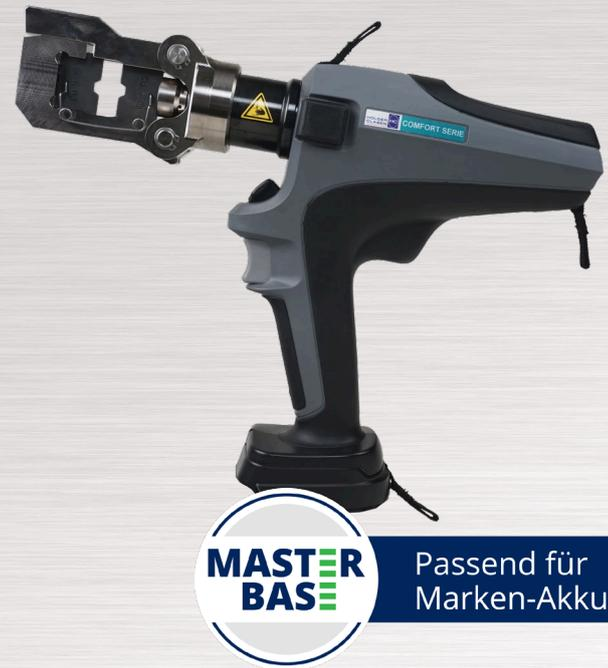
Dieses Werkzeug verpresst Kabelschuhe und Verbinder mit handelsüblichen Federbügel- (F) oder Zapfen-Pressesätzen (Z) bis 240 mm<sup>2</sup> nach DIN. Das optimale Leistungsgewicht und die schmale Bauform sind optimal für den Einsatz im Schaltschrankbau, der Elektromontage und bei Energieversorgern.
