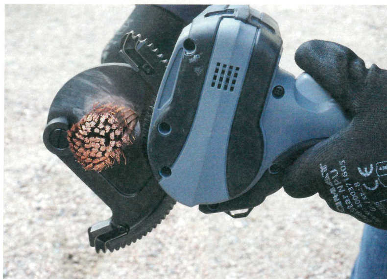
Der Kabelschneider RS 5-F schneidet fein- und feinstdrähtige Litzenleiter. Bilder: Holger Clasen
